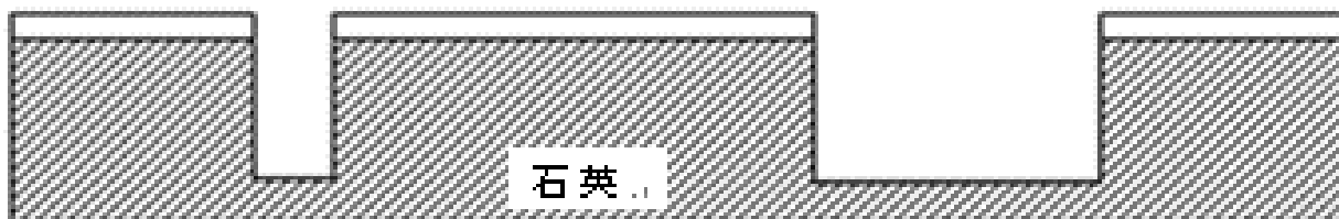
ドライエッチング処理（異方性エッチング）加工断面
