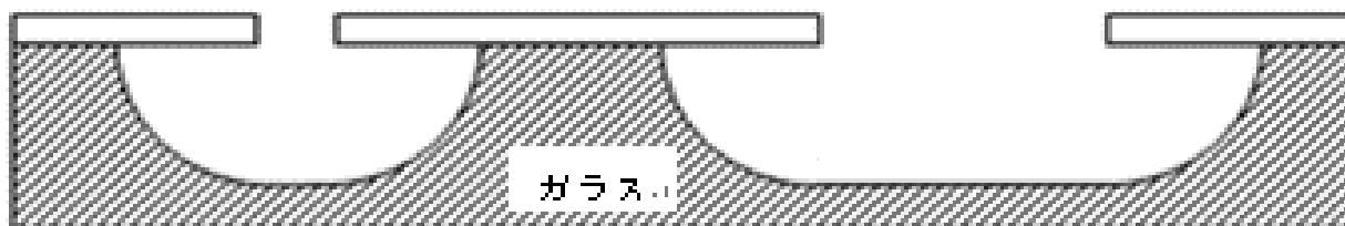
フッ酸ウエット処理（等方性エッチング）加工断面
